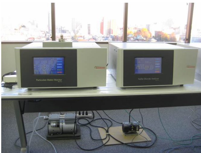
PM2.5 計 紀本電子工業:PM-712(左) S02 計 紀本電子工業:SA-731(右)
