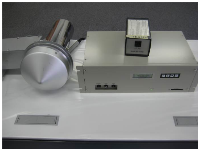
気象計: 小笠原計器製作所:OKSAM4100 (温湿度センサ、風向/風速用模擬センサ)
