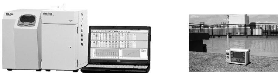
図2 市販の大気中水銀測定装置(左)とサンプリング装置(右)
