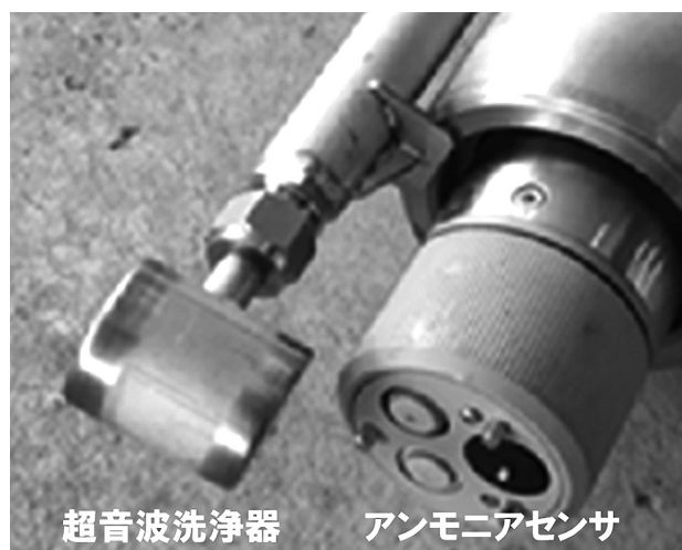
図5 超音波洗浄器付のアンモニアセンサ
