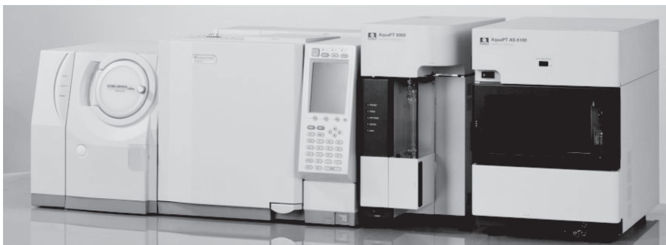
写真 (右) がパージ&トラップで (左) がガスクロマトグラフ/質量分析計である。各ユニットは、右からパージ&トラップ用オートサンプラー、パージ&トラップ本体、ガスクロマトグラフと質量分析計である。横幅はGC/MS約860mmでパージ&トラップ約570mmである。
