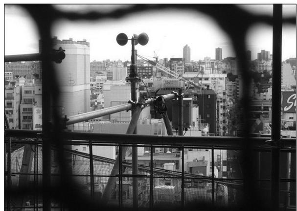
高層ビル建築現場の自己発電式無線風速計
